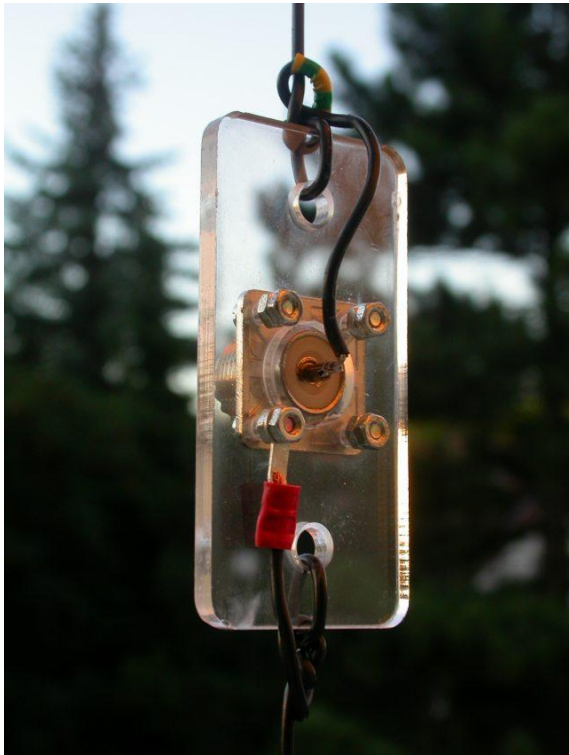
Bild 3: Das Mittelstück des Strahlers
