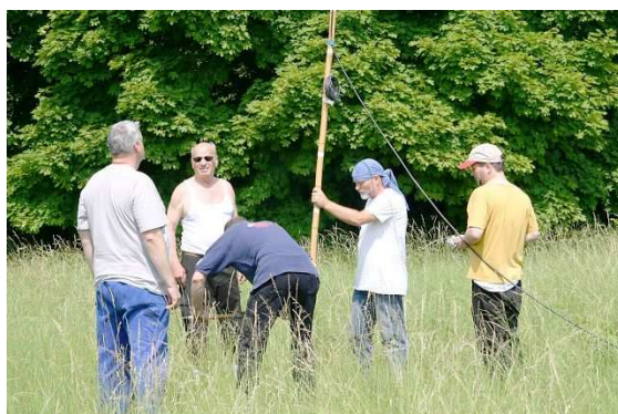
Niedrig aufgehängter 80m Dipol auf 3 Bambusrohren
