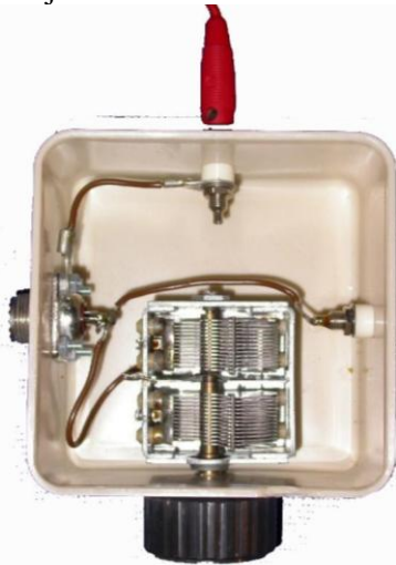
Bild 4: Abstimmbox mit 500 pF Drehkondensator
